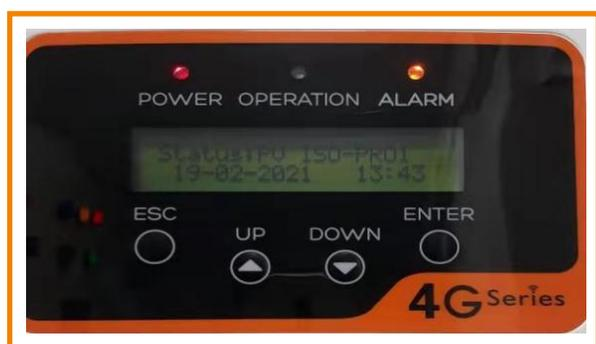
Figura 5: El sistema fotovoltaico tiene un problema de baja impedancia
