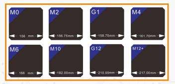
La potencia del módulo fotovoltaico de obleas de silicio de 182 mm puede superar los 540 W y la potencia del módulo fotovoltaico de obleas de silicio de 210 mm supera los 600 W. Algunos fabricantes de módulos han combinado sus nuevas tecnologías para alcanzar una potencia de módulo de más de 700 W.
