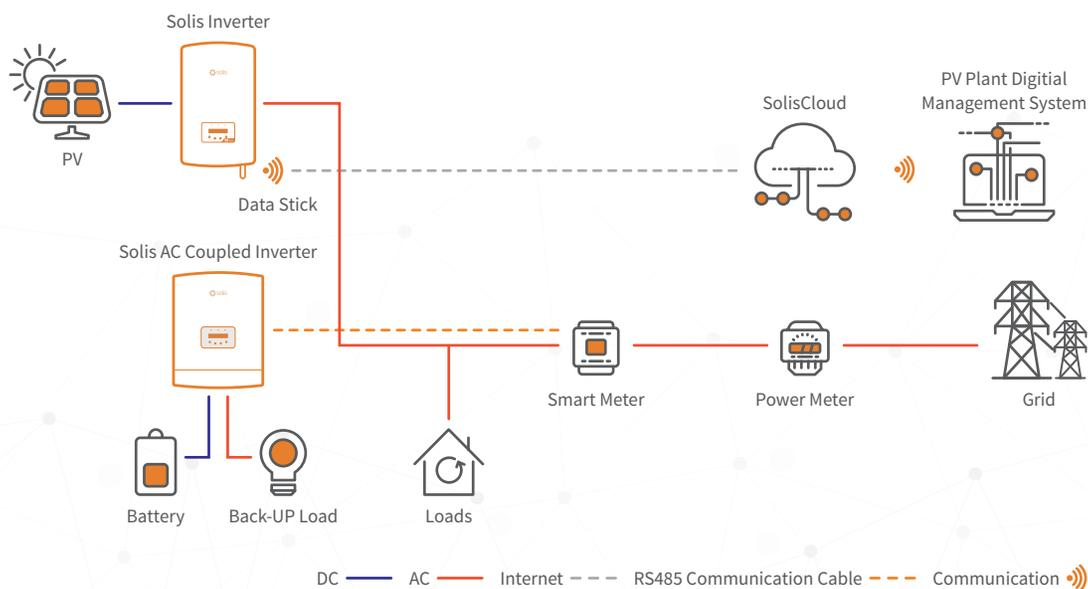
**Los beneficios del sistema de almacenamiento de energía fotovoltaica con acoplamiento CC/CA son los siguientes:**
