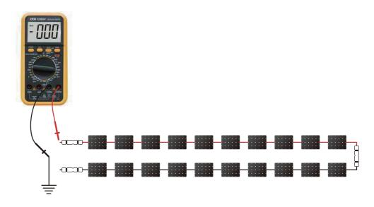
Si la tension de chaîne de la borne PV+/PV- à la terre est déséquilibrée, il est possible de déterminer que la chaîne PV présente un défaut de mise à la terre. Par exemple, la tension d'une polarité à la terre est de 0 V ou proche de 0 V, et la tension de l'autre polarité à la terre dépasse 600 V sans changement de valeur.
