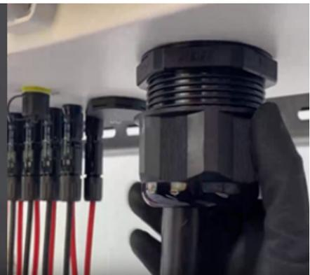
③ Vergewissern Sie sich, dass die AC-Dichtungsabdeckung fest mit dem AC-Kabel verbunden ist.
