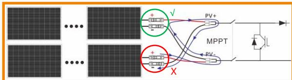
Comme indiqué dans la figure ci-dessus, pour deux chaînes dans le même MPPT, la polarité d'une chaîne est connectée correctement et l'autre est inversée. Cela entraînera le court-circuit direct entre les deux chaînes. Dans ce cas, l'onduleur indiquera que la tension d'entrée de MPPT est de 0 V, ce qui n'endommagera pas l'onduleur, mais le court-circuit endommagera les modules PV.
