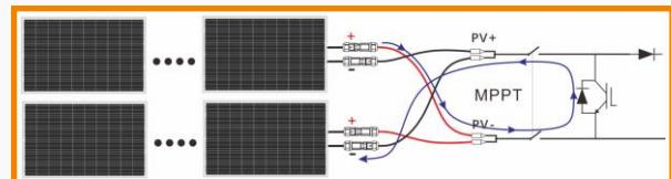
Comme indiqué dans la figure ci-dessus, les polarités des deux chaînes PV dans le même MPPT sont inversées. Une fois l'interrupteur CC de l'onduleur fermé, chaque chaîne forme un court-circuit avec la diode antiparallèle IGBT du circuit de suralimentation via l'interrupteur CC et est éteinte. L'interrupteur CC sera endommagé par un arc électrique et le MPPT de ce circuit ne fonctionnera pas correctement.
