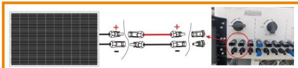
3. Il est recommandé d'utiliser un multimètre pour mesurer la polarité du connecteur de la chaîne PV avant de brancher.
