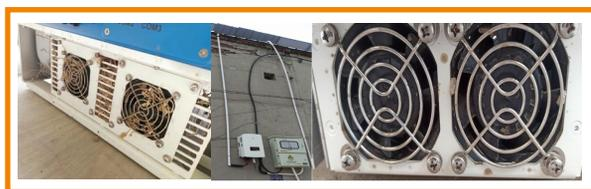
Abbildung 3: Verschmutzungen blockieren die Luftkanäle und Lüfter des Wechselrichters und führen zum Ausfall des Wechselrichters
