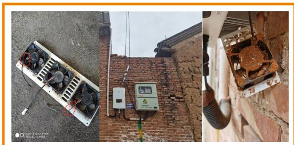
Figura 2: El roedor muerde el cable del ventilador y la arena se atasca en el ventilador.
