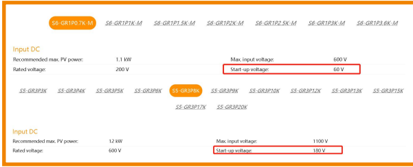
Şekil 2: Farklı invertörlerin başlangıç gerilimleri
